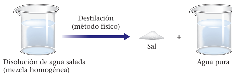
Figura 3.7 No se produce cambio químico cuando se destila agua salada.
